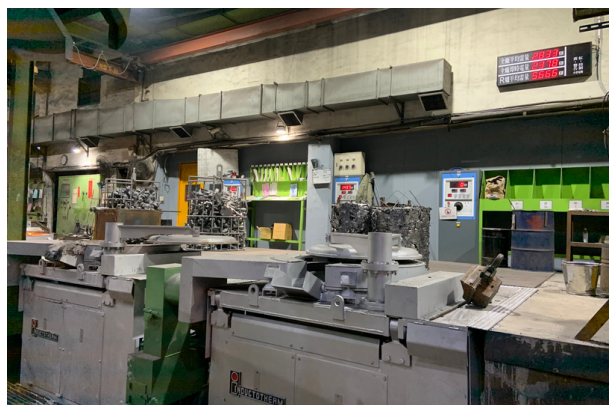
啟用新式中周波溶解爐，耗能減少8%，締造綠色鑄造實績
